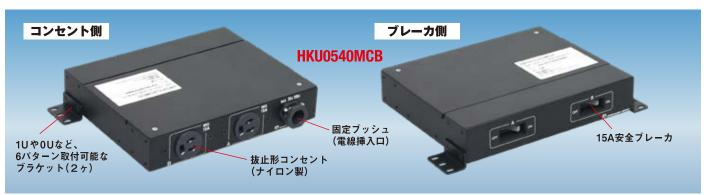
取り外しが可能なブラケットにより、19インチラックの垂直方向に取り付けて使用することが可能です。またブラケットは本体両側へ6パターンの取付が可能です。コンセント側・ブレーカ側のどちらでもラックの正面に設置することができます(ブラケット止ねじ4本付属)。ブレーカのハンドルは、万が一の誤接触による
