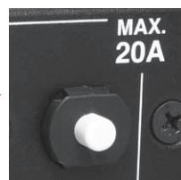
過電流感知状態 (ピンが突出して電流を遮断します)
